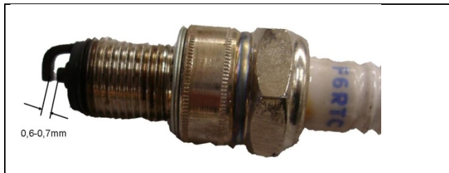
Figur 13: Elektrodeavstand
