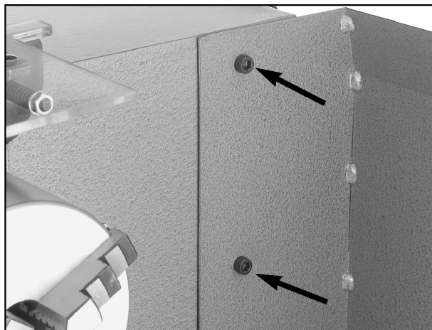
Joonis 1. Kahe pesapeakruviga kinnitatakse tagaseina vasak pool tööpingi külge.
