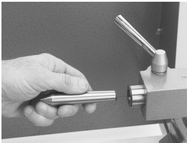
Nekustīgā centra ievietošana aizmugurējā balsta cilindrā
