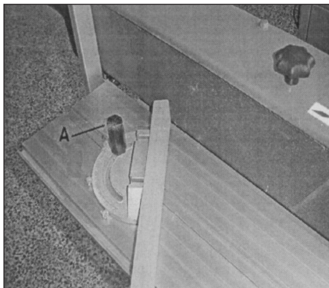
Fig. 7. Gjæringsanlegg kan valgfritt låses fast fra 45° til 90° med hjelp av justeringshåndtaket A.
