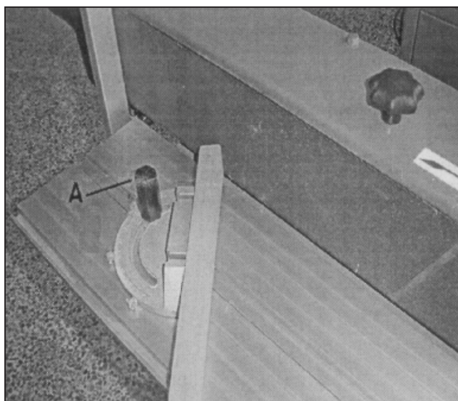
Joon 7. Kaldtuge saab fikseerida vahemikus 45° kuni 90° käepidemega A.
