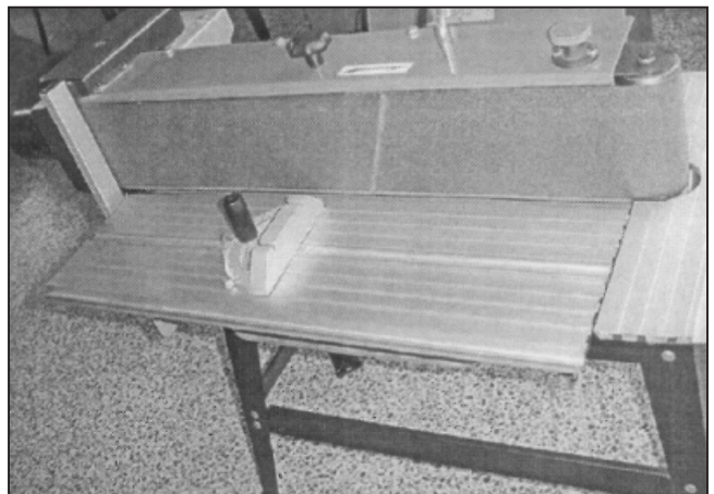
2. pieš. Įstatykite šlifavimo juostą vertikalioje padėtyje (ant briaunos)
