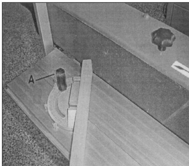
Rys. 7. Prowadnica ukośna może być ustalana pod dowolnym kątem w zakresie 45° – 90° przy użyciu pokrętki ustalającej A.
