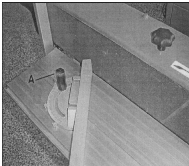
7.att. Aizturi uz darbvirsmas iespējams stingri nostiprināt 45°-90° leņķī ar regulējoša rokrata ā palīdzību.
