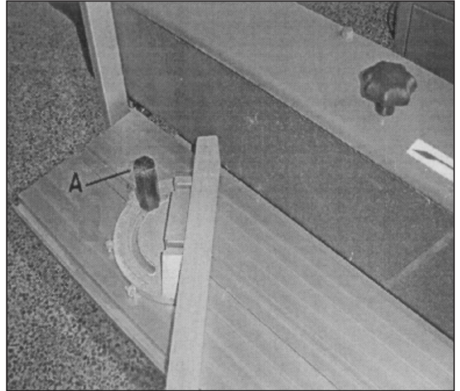
7. kuva. Hiomahihnan tuki valinnan mukaan saa lukittaa 45° - 90° kulmaan säätökahvan A avulla.
