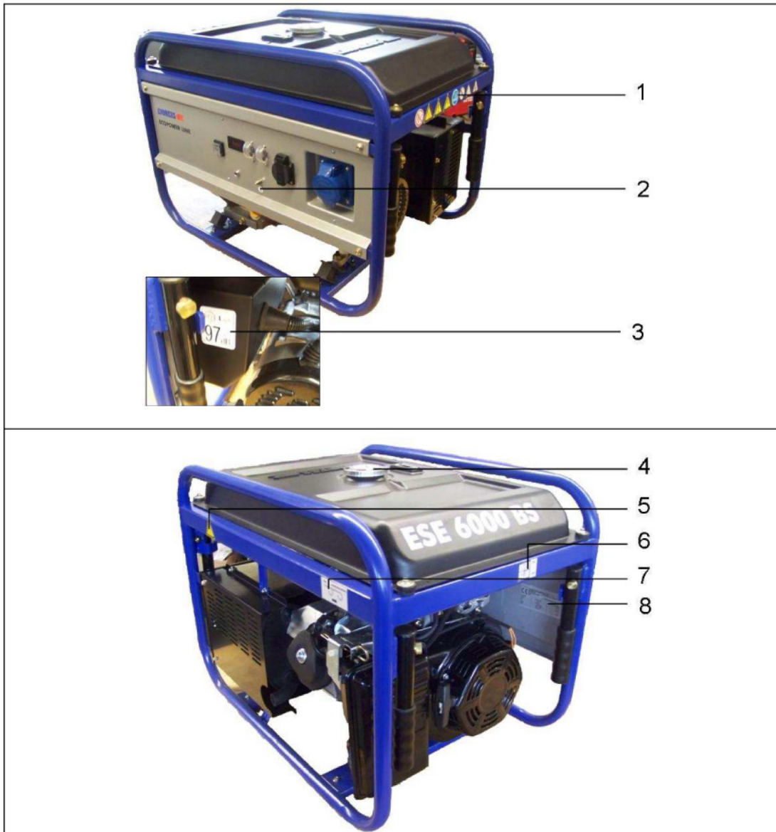
Fig. 2.1: Etiketter på generatoren
